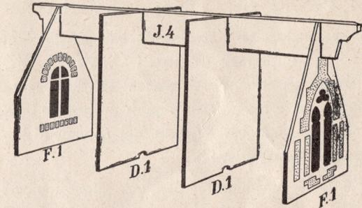
Fig. 13. — Petits Pignons et Panneaux encochés, assemblés par une Faitière de quatre encoches.
