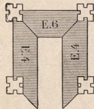
Fig. 17. — Utilisation de la Corniche: raccord double de décrochement (E. 6).
